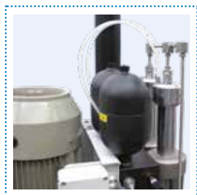
Accumulateur à membrane d'azote pour la gestion di circuit de retour des cylindres hydrauliques
