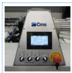
Contrôle électronique de la pression de découpe
